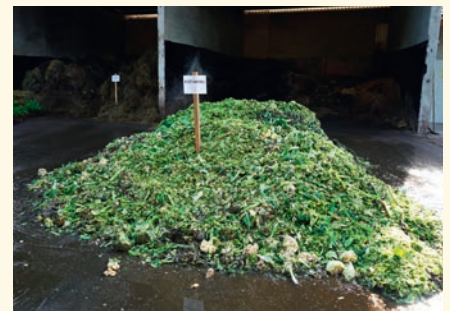
MIST, GÜLLE UND WEITER RESTSTOFFE DIENEN ALS «FUTTER» FÜR DIE BAKTERIEN IM FERMENTER DER BIOGASANLAGE.
